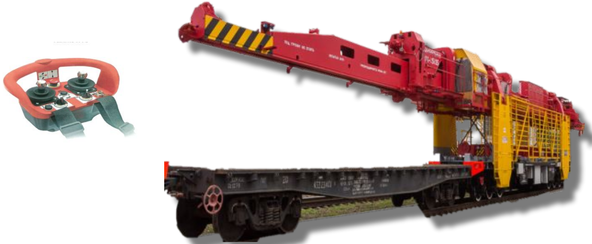
Система радиуправления путееукладочным краном
