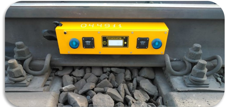
Сигнализатор приближения поезда «Сигнализатор-П»
