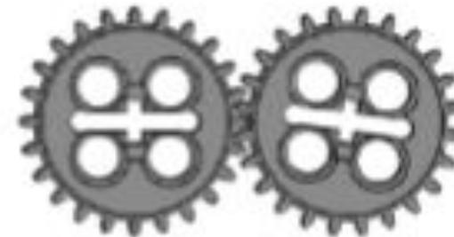
**Зубчатые колёса** используют обычно парами с разным числом зубьев, а иногда и с одинаковым числом зубьев. Зубчатые колёса зацепляются зубчиками друг за друга и получается передача силы движения. Этот простой механизм называется **зубчатой передачей**. Скорость вращения ведущего и ведомого колес одинаковая, поскольку у них одинаковое количество зубьев. Передаточное отношение зубчатого зацепления 1:1. Ведущее и ведомое колеса вращаются в одном направлении.
