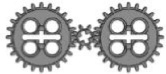
**Маленькое колесо** является промежуточным зубчатым колесом. Оно не изменяет скорость вращения большого колеса, оно изменяет только направления его вращения. **Промежуточное колесо** вращается в противоположном направлении.
