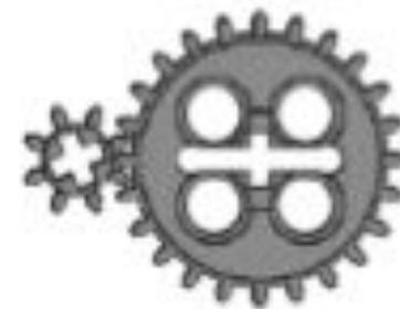
***Понижающая зубчатая передача**, в которой малое зубчатое колесо вращает большое ведомое и в результате **скорость вращения уменьшается**. Понижающая передача позволяет получить большой крутящий момент.*
