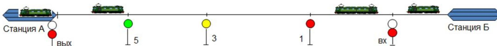
При автоблокировке перегон делится на несколько блок-участков, на каждом из которых может одновременно находиться не более одного поезда
