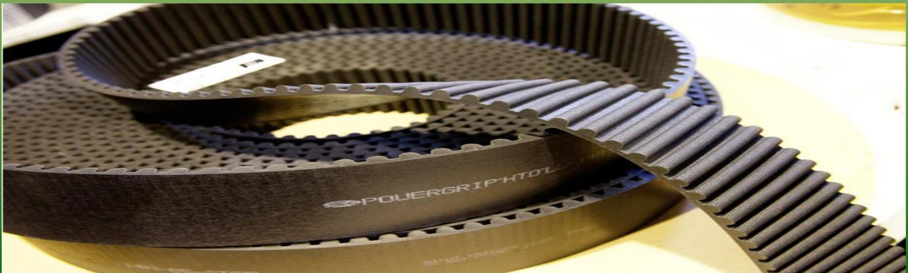
*Ременная передача* относится к передачам трением с гибкой связью и может применяться для передачи движения между валами, находящимися на значительном расстоянии один от другого. Она состоит из двух шкивов (ведущего, ведомого) и охватывающего их ремня.
