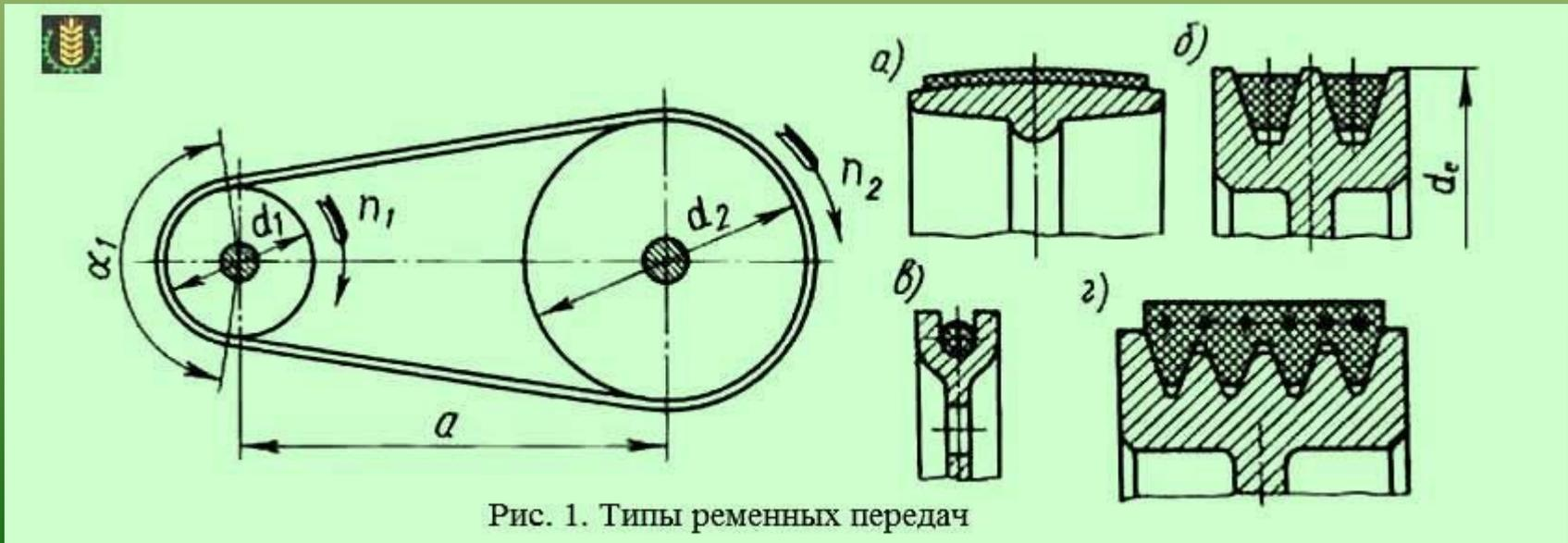
Рис. 1. Типы ременных передач
