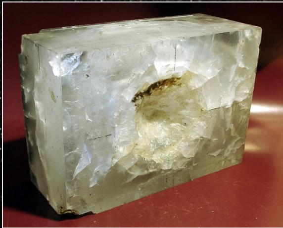
Кратеры в толстой мишени из полиметилметакрилата
