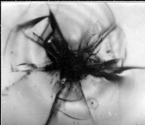
Кратер в стекле от удара частицы Al с v \sim 8 км/с
