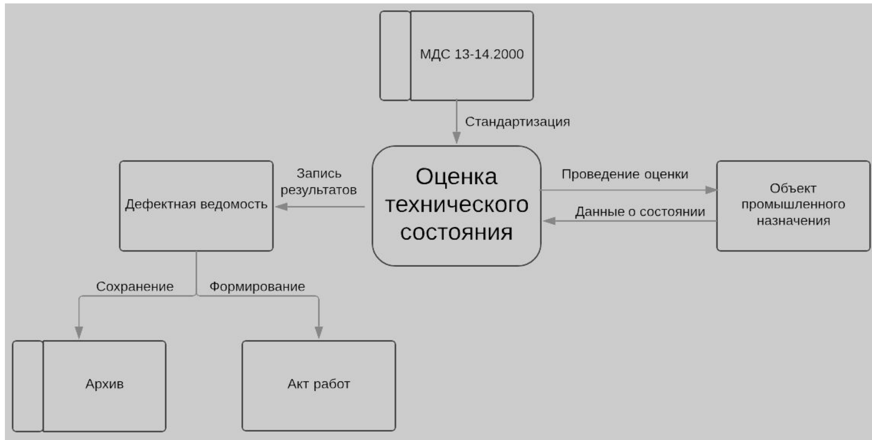
Рисунок 1 - Схема информационных процессов предметной области
