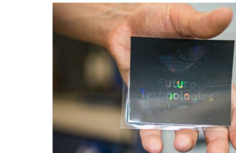
Напечатанная специалистами ИТМО голограмма. Фото: пресс-служба ИТМО Сотрудники Университета информационных технологий, механики и оптики (ИТМО) разработали специальные чернила, позволяющие значительно удешевить технологию и способ изготовления радужных голограмм, которые повсеместно используются для защиты изделий от пиратства и фальсификации. О результатах исследования, опубликованного в журнале Advanced Functional Materials, сообщается на портале «Роснаука».
