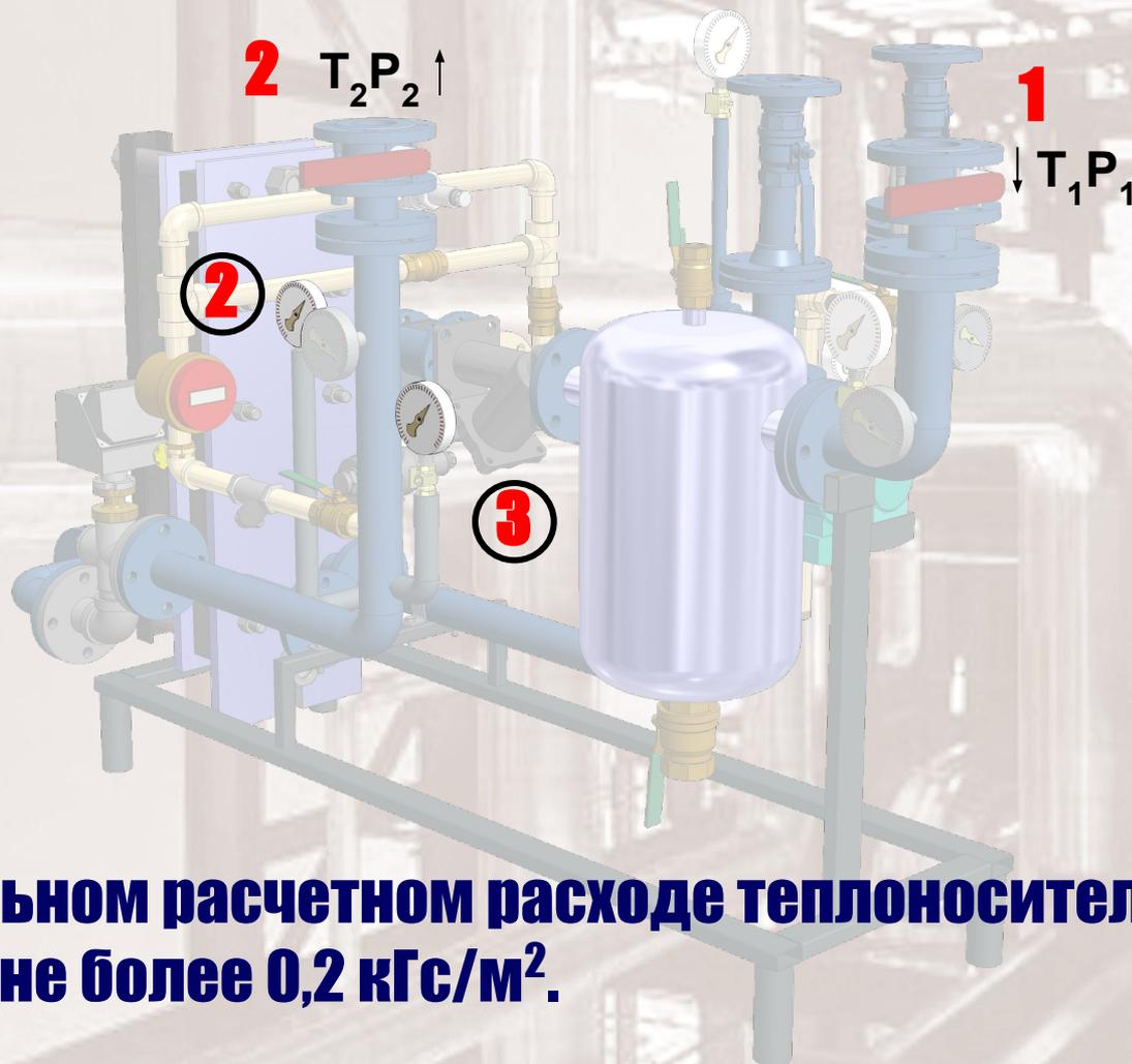
**При максимальном расчетном расходе теплоносителя должна быть разница не более  $0,2 \text{ кгс/м}^2$ .**
