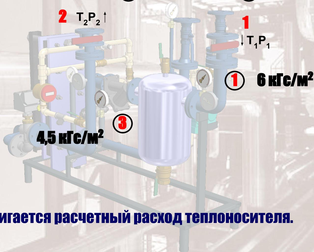
**При этом достигается расчетный расход теплоносителя.**
