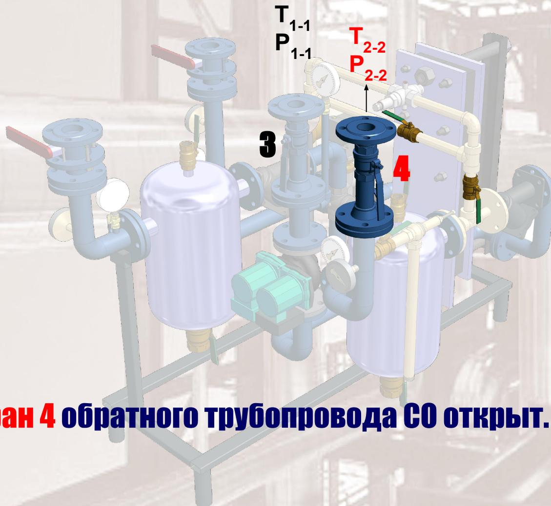
**Шаровой кран 4** обратного трубопровода СО открыт.
