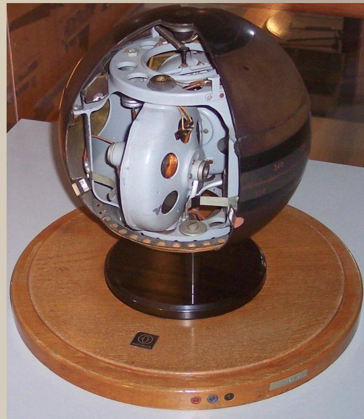
Механический указатель направления географического меридиана, предназначенный для определения курса объекта, а азимута ориентируемого направления. Принцип действия гирокомпаса основан на использовании свойств суточного вращения Земли.
