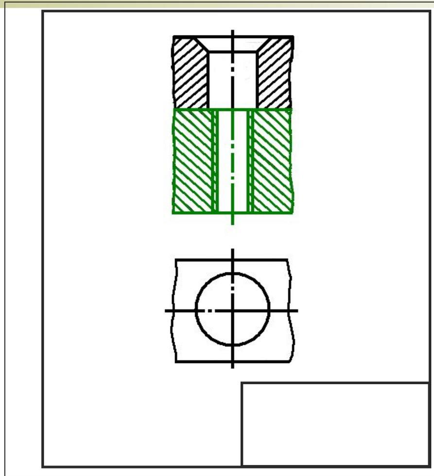
Выполните изображение нижней соединяемой детали.
