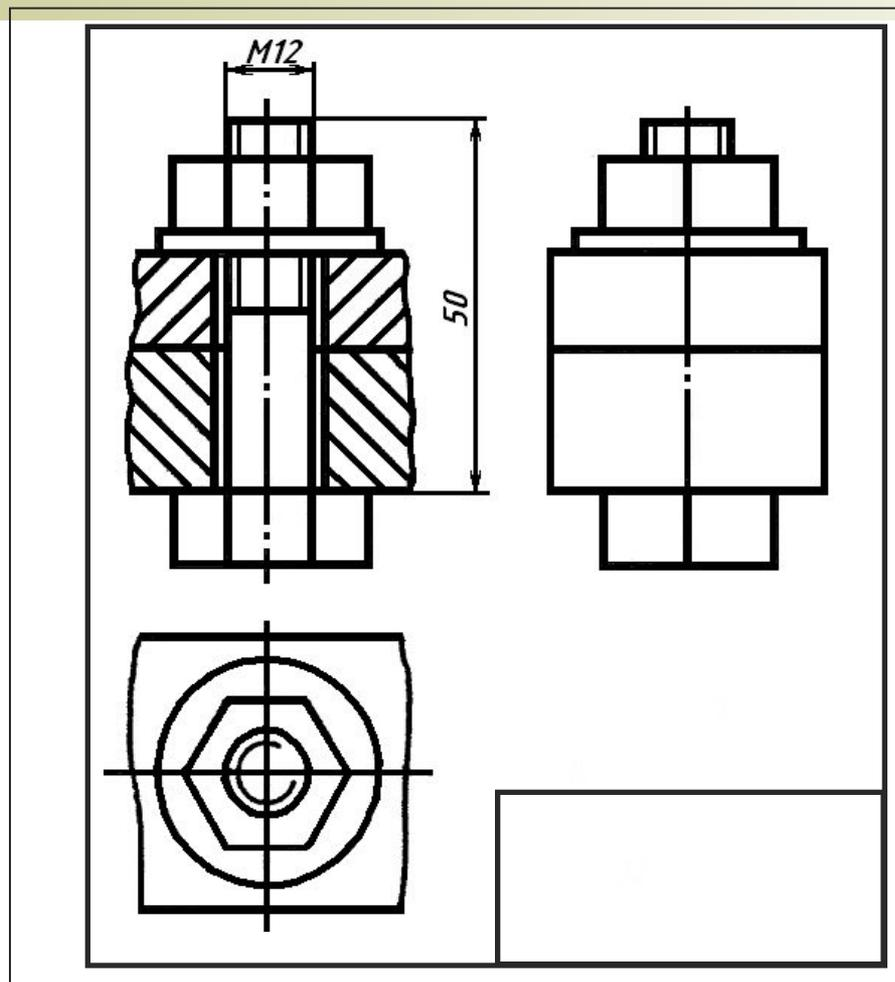
Нанесите размеры: **размер резьбы и длину болта.**
