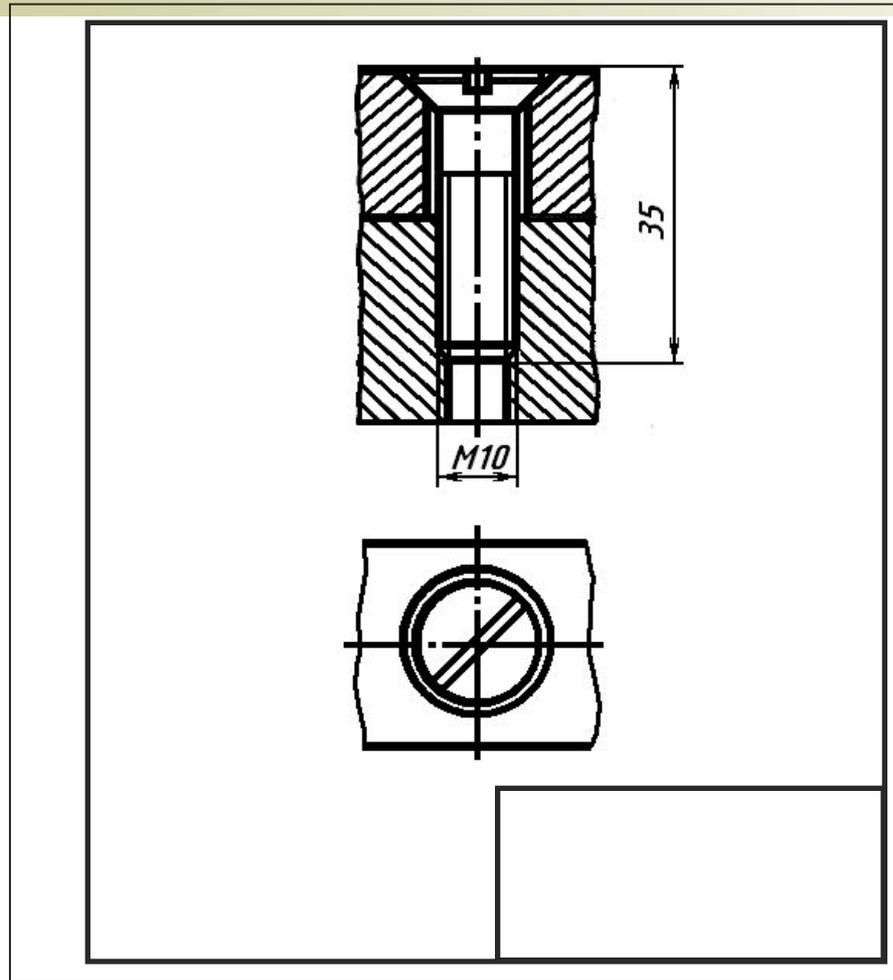
Нанесите размеры: размер резьбы и длину винта.
