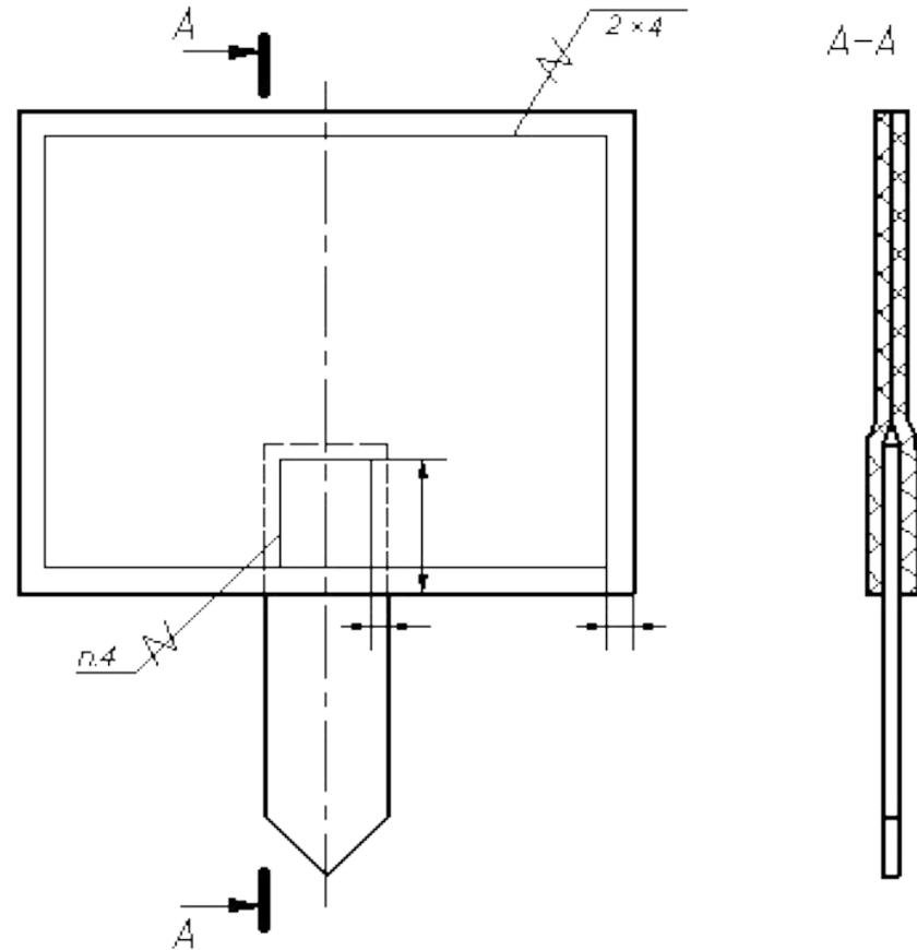
Соединение, получаемое при помощи металлических скобок, следует обозначать условным знаком, выполненным сплошной основной линией и нанесенным на линии-выноске:
