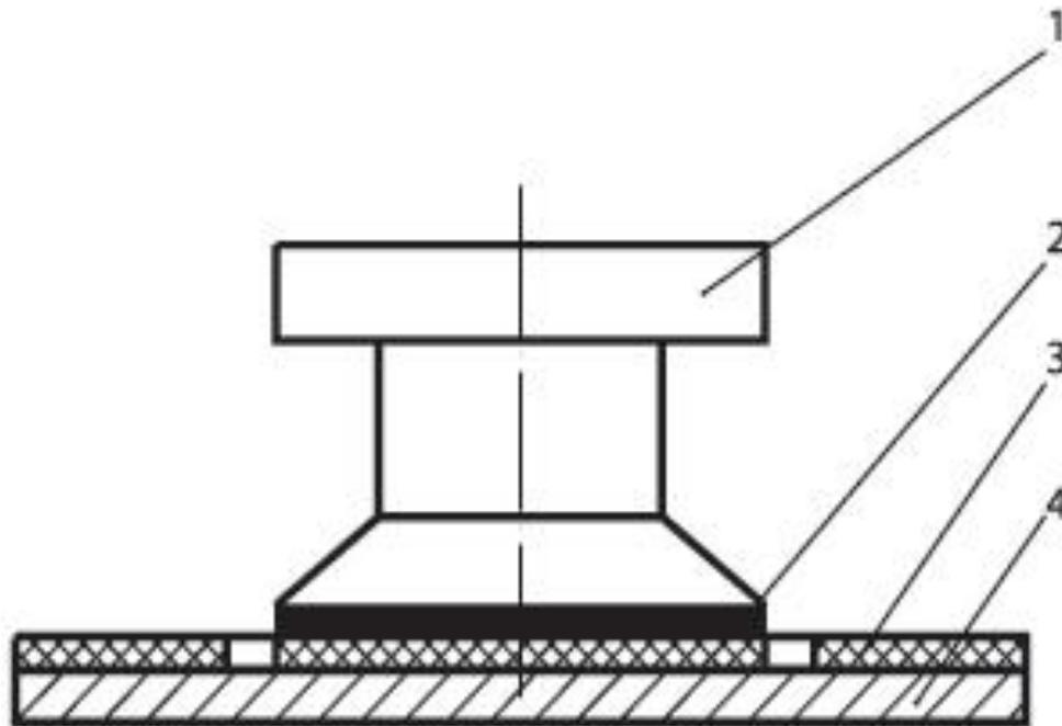
Соединения, получаемые сшиванием, следует изображать на чертежах тонкой сплошной линией и обозначать условным знаком, выполненным сплошной основной линией и нанесением на линии-выноске.
