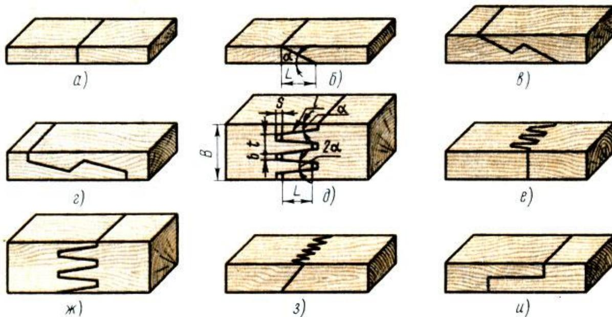
Сложная форма стыков обеспечивает прочное, устойчивое к разрыву соединение
