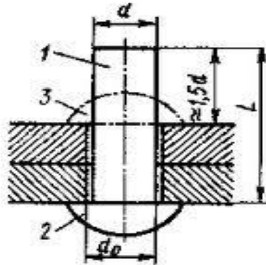
Рис. 3.7. Заклепочное соединение
