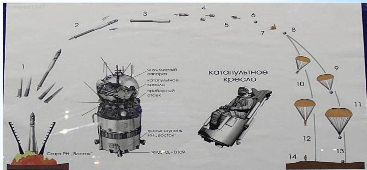
На высоте семи километров в полном соответствии с планом Гагарин осуществил катапультирование. После чего модуль и космонавт в скафандре стали спускаться вниз на двух разных парашютах
