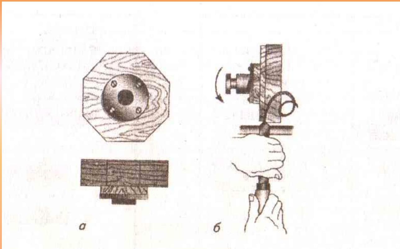
Крепление (а) и точение (б) заготовки на планшайбе
