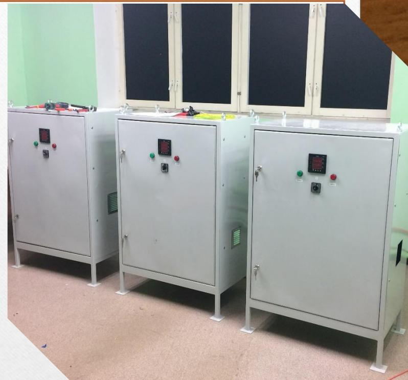
ТКИУЭС перед отгрузкой тестируются на стенде по номинальной мощности
