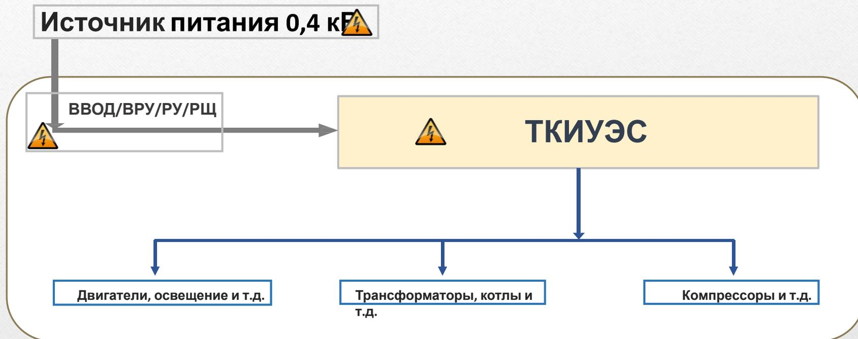
ТКИУЭС устанавливается в разрыв фаз и нуля
