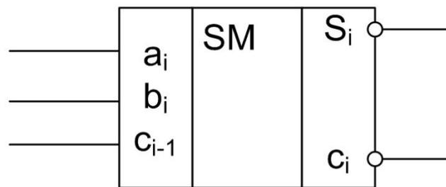
$$\bar{S}_i = \overline{a_i \cdot \bar{c}_i \vee b_i \cdot \bar{c}_i \vee c_{i-1} \cdot \bar{c}_i \vee a_i \cdot b_i \cdot c_{i-1}}$$
