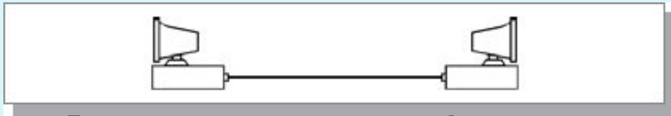
Двухточечное соединение компьютеров без концентратора
