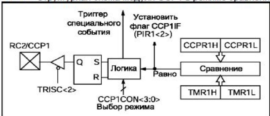
Рис. 8-2 Структурная схема модуля CCP1 в режиме сравнения
