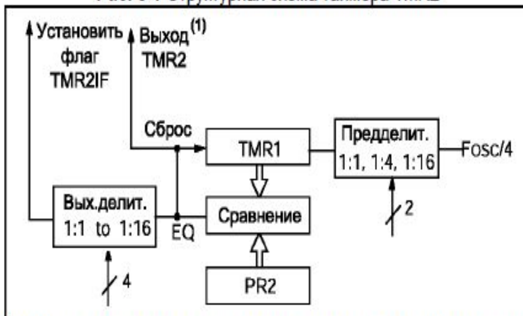
Рис. 8-1 Структурная схема таймера TMR2
