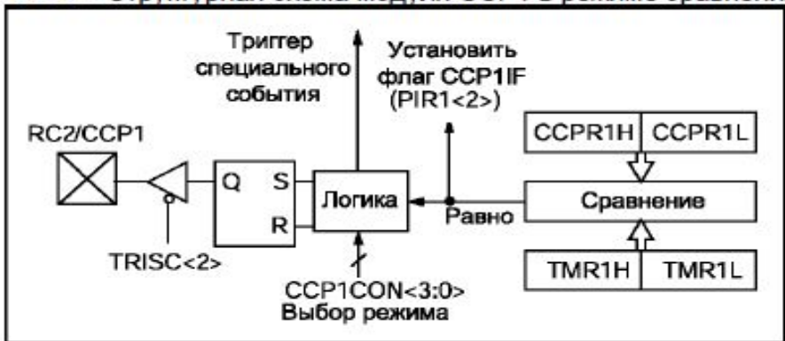
Рис. 8-2 Структурная схема модуля CCP1 в режиме сравнения
