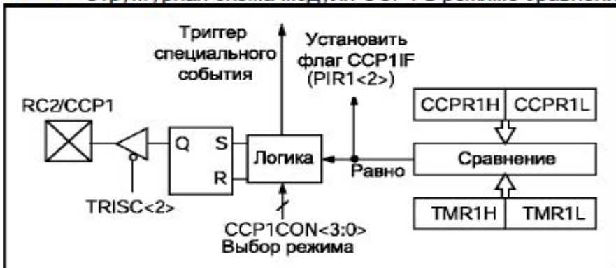
Рис. 8-2 Структурная схема модуля CCP1 в режиме сравнения
