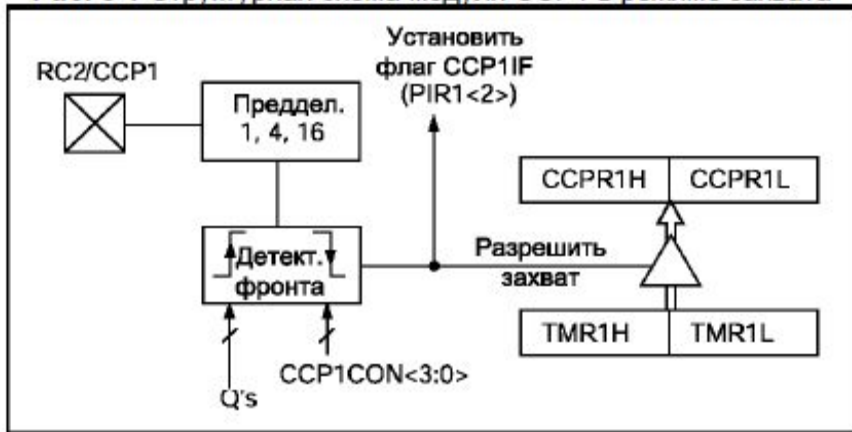
Рис. 8-1 Структурная схема модуля CCP1 в режиме захвата
