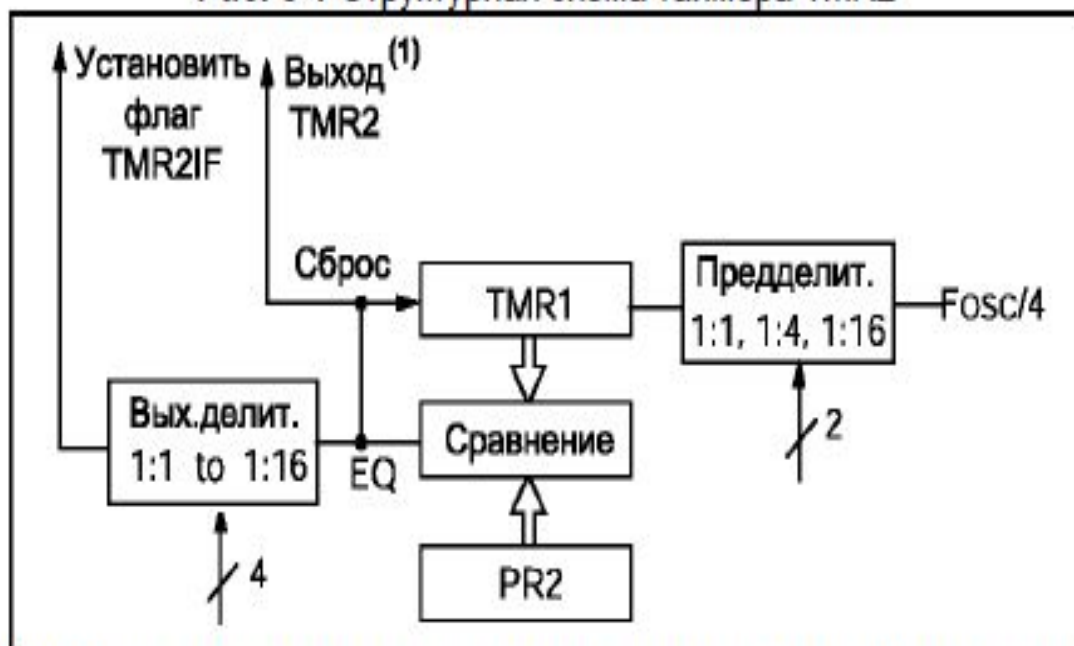
Рис. 8-1 Структурная схема таймера TMR2
