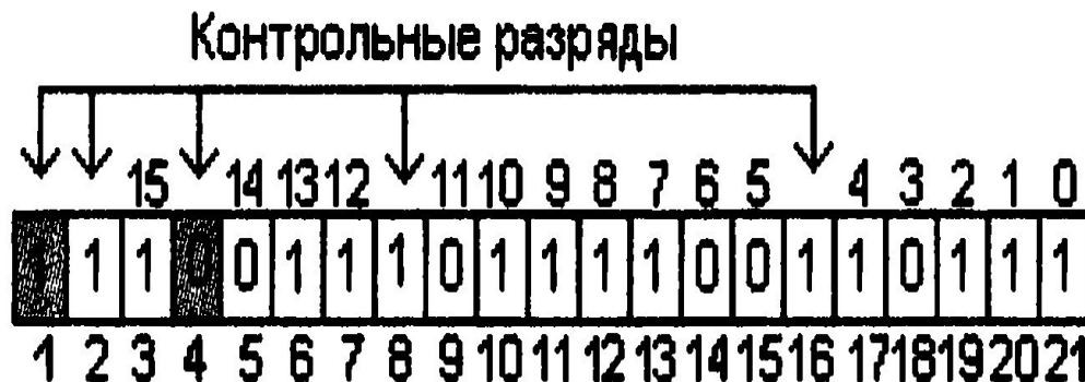
Рис. 2.18. Определение номера ошибочного бита
