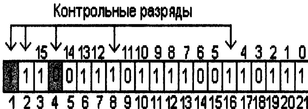
Рис. 2.18. Определение номера ошибочного бита
