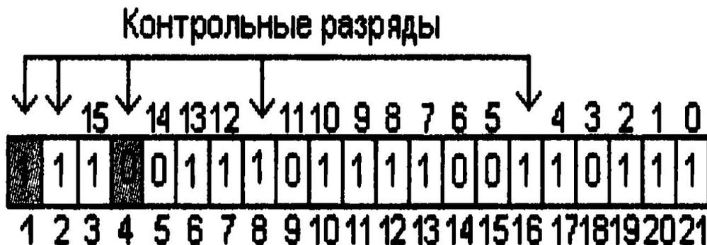
Рис. 2.18. Определение номера ошибочного бита
