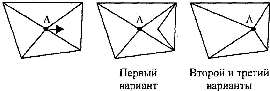
Рис. 4.8. Результат изменения координат одной вершины
