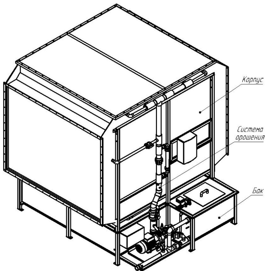
Вентиляционный фильтр ФК-ИС состоит из корпуса и бака для регенерирующего раствора.
