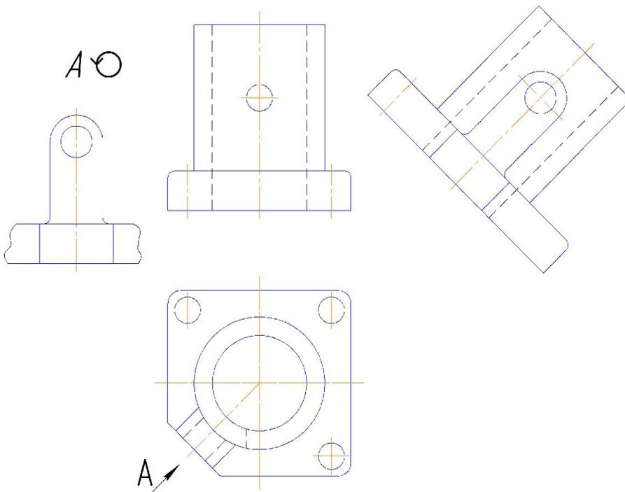
**Дополнительный вид** - изображение, получаемое проецированием на плоскости, непараллельные основным плоскостям проекций.
