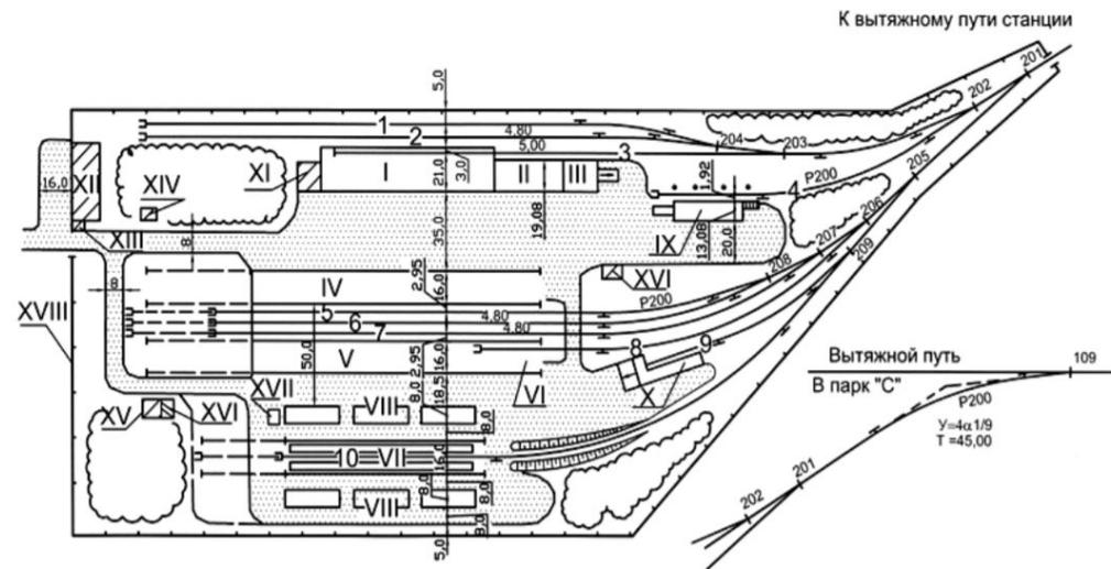
Рис. 12. Схема грузового двора тупикового типа
