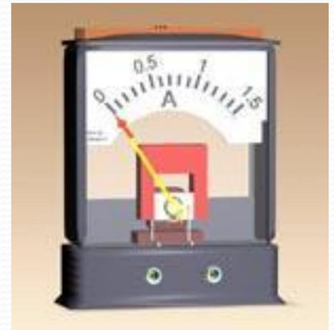
**Амперметр** по своему принципу действия и устройству похож на гальванометр. Его работа основана на **магнитном действии тока**.
