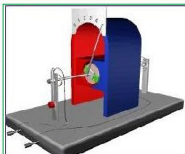
Под действием магнитного поля катушка с током поворачивается. Угол поворота катушки зависит от силы тока в ней.
