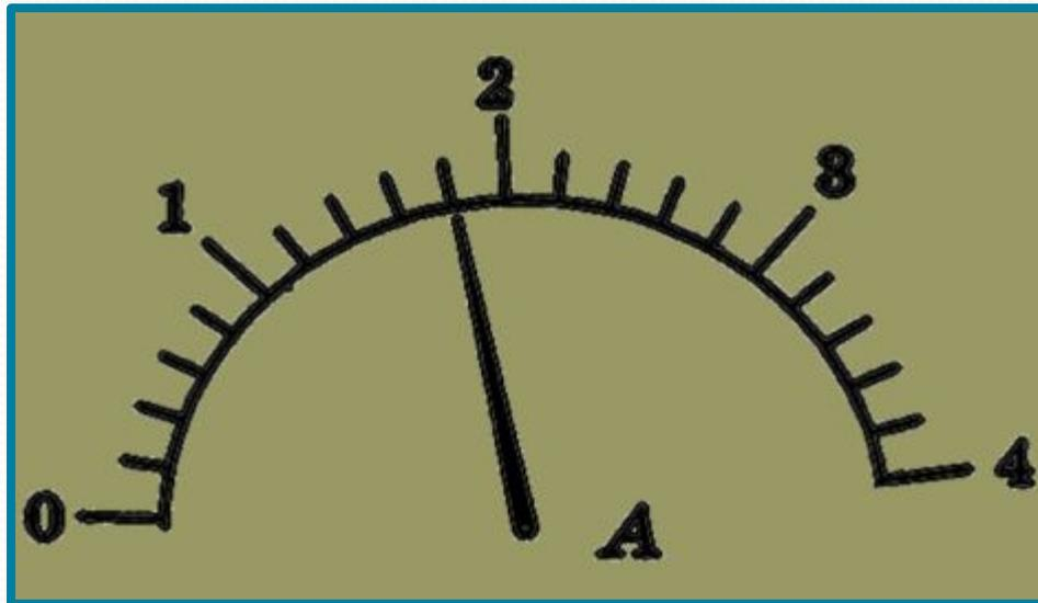
1. Пределы измерения: от 0 до  $I_{\max} = 4\text{A}$ .
