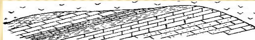
Рис. 2б Схема неоднородного массивного резервуара
