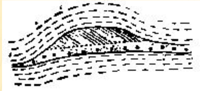
Рис. 3 Резервуар, литологически ограниченный со всех сторон практически непроницаемыми породами
