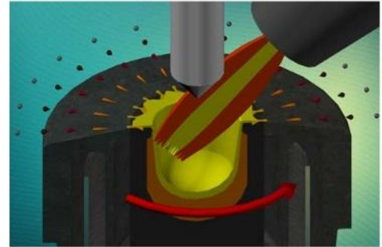
Схема распыления на установке «Сферамет» при использовании штанги в качестве исходного материала.
