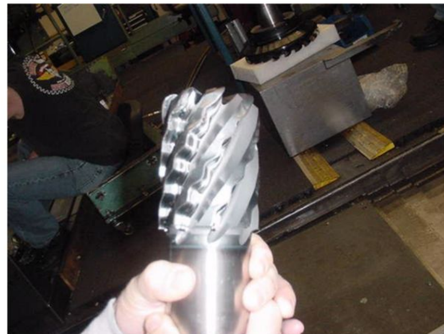
Фреза с твердосплавными вставками фреза из быстрорежущей стали HaniTa.
