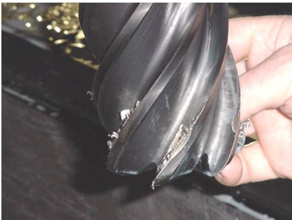
Налипание титановой стружки на фрезу
