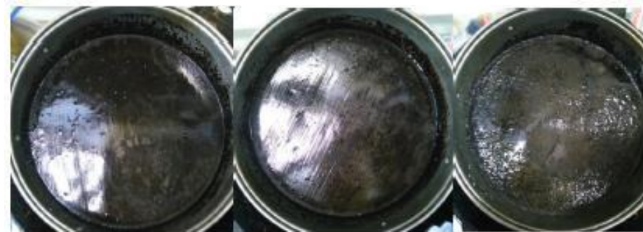
Тестирование жидкости (эмульгированная кислота не образует осадка, а также эмульсии при перемешивании с пластовой нефтью)
