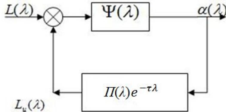
Структурная схема системы стабилизации манипулятора с регулятором самого общего вида
