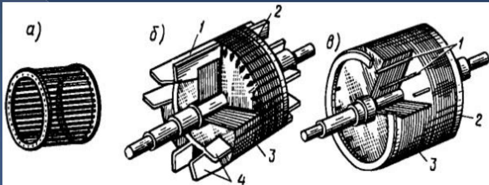
Рис. 1.6. Конструкция короткозамкнутого ротора:
