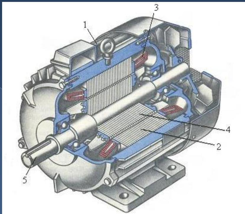
асинхронной машины с короткозамкнутым ротором в разрезе: 1 – станина, 2 – сердечник статора, 3 – обмотка статора, 4 – сердечник ротора с короткозамкнутой обмоткой, 5 – вал.
