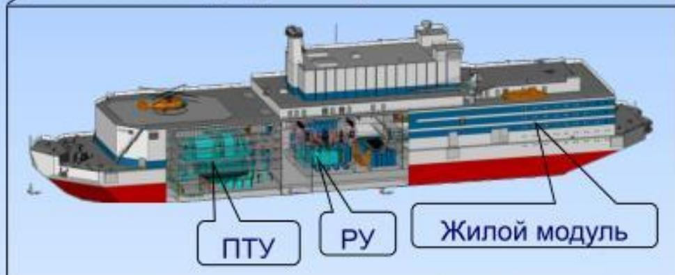
**Плавучий энергетический блок (ПЭБ)** изготавливается в заводских условиях и поставляется в полностью готовом виде
