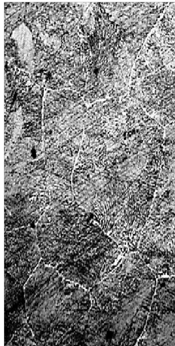
Рис. 20.7. Равновесная структура доэвтектоидной (а), эвтектоидной (б) и заэвтектоидной стали (в)
