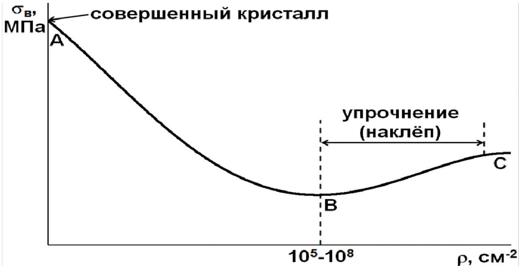
Рис. 4.5. Зависимость предела прочности кристалла от плотности линейных дефектов (дислокаций) (Кривая Одингга)
