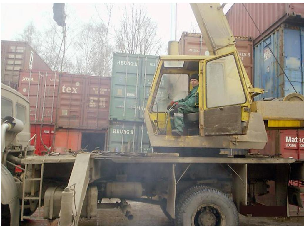
это пространство, в котором возможно воздействие на работающего опасного или вредного производственного фактора. Опасная зона может быть четко ограничена (например, для оператора машины – пространство кабины управления) или может изменять положение в пространстве и размеры (например, для стропальщиков – зона движения груза при его перемещении краном)
