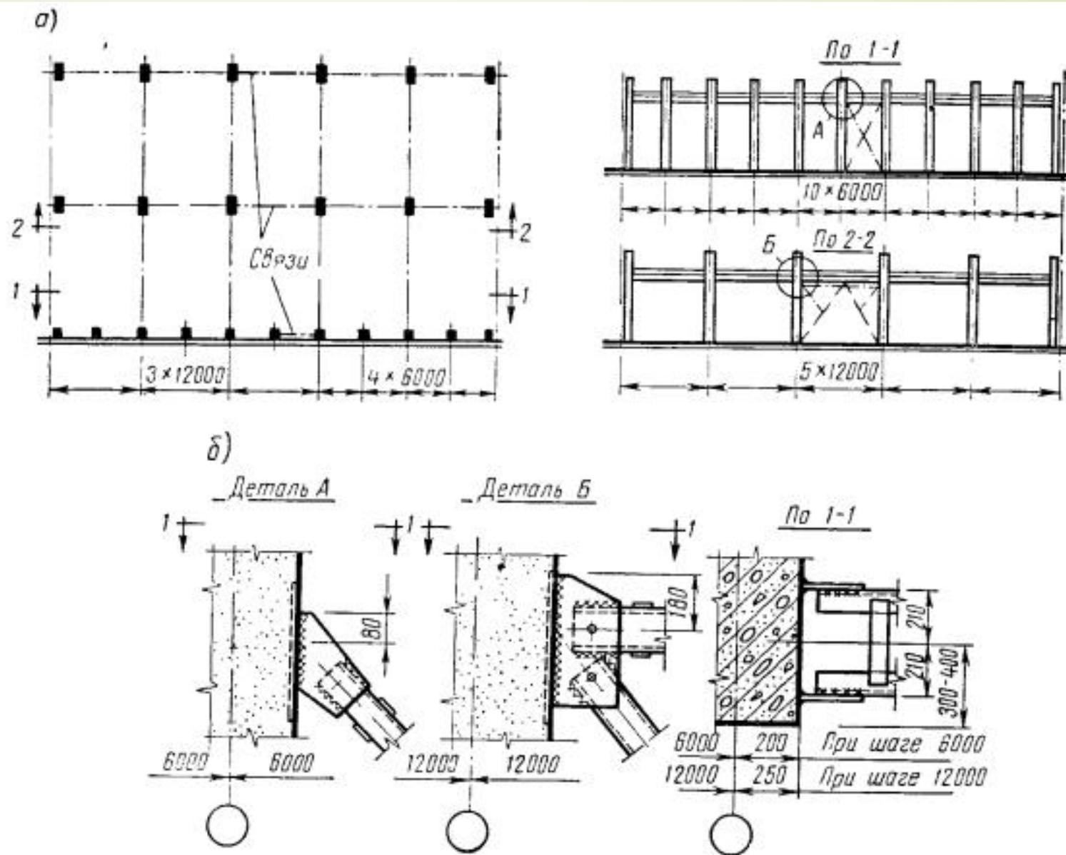
Рис. 35. Связи между железобетонными колоннами:
