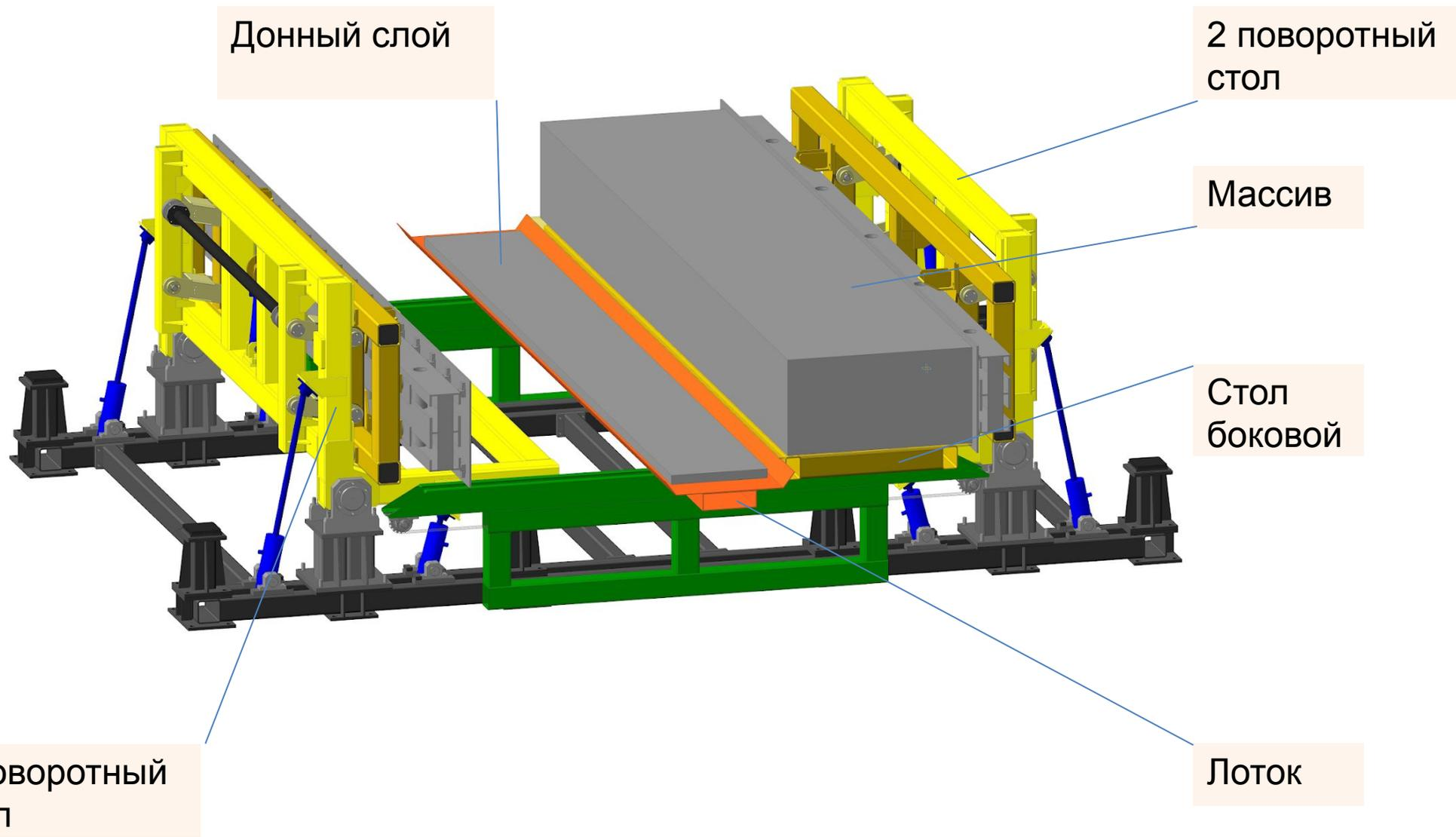
Поворотные столы вращаются на 90 градусов. Лоток с донным слоем выезжает в зону сброса.
