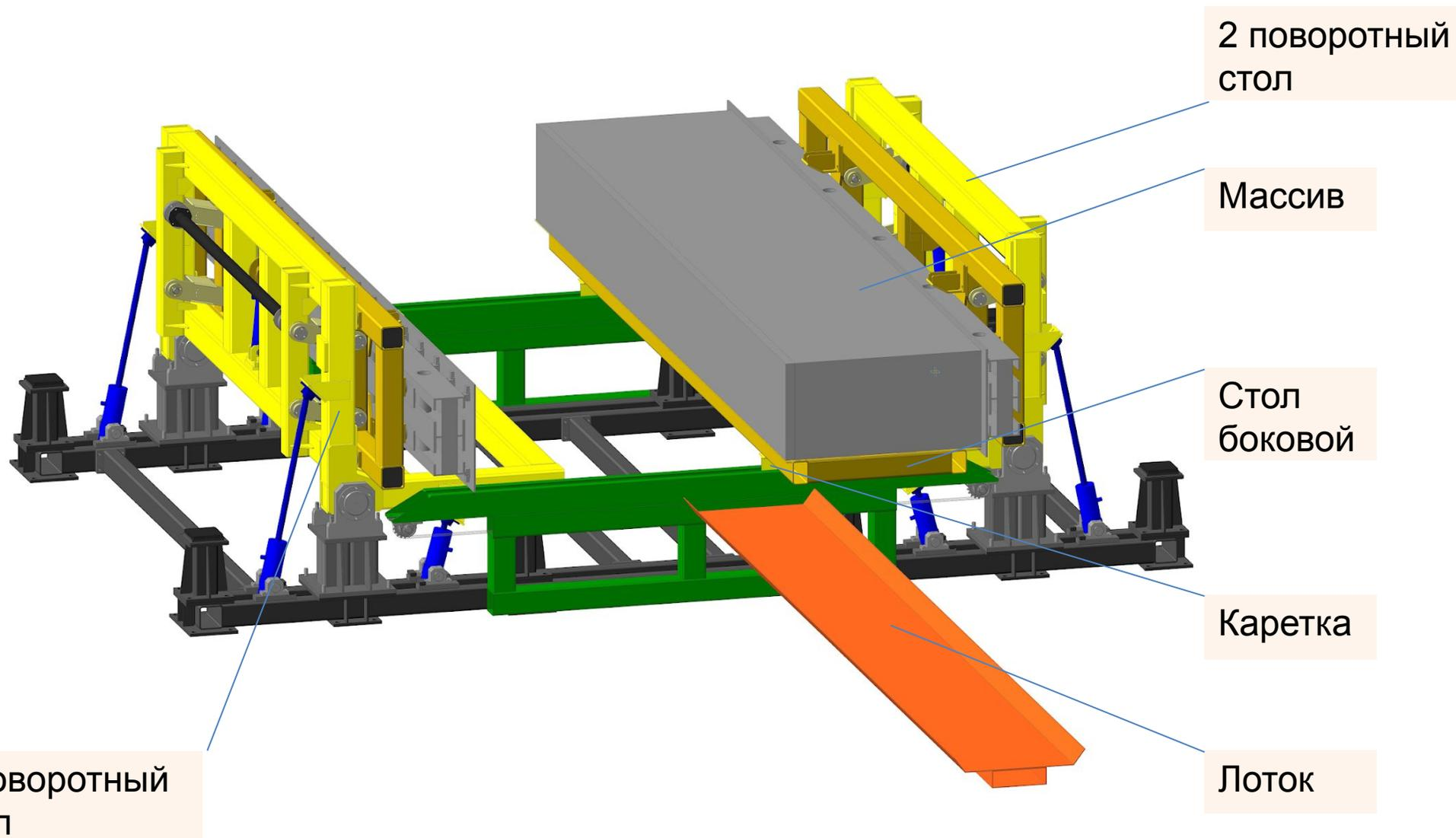
Лоток задвигается между поворотными столами.
