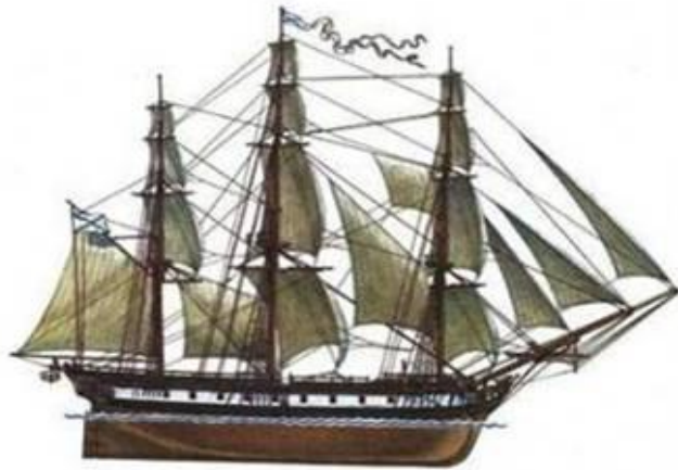
«Восток» (построен в 1818 году в Петербурге, водоизмещение - 900 тонн, вооружение - 28 орудий, экипаж - 117 человек)
