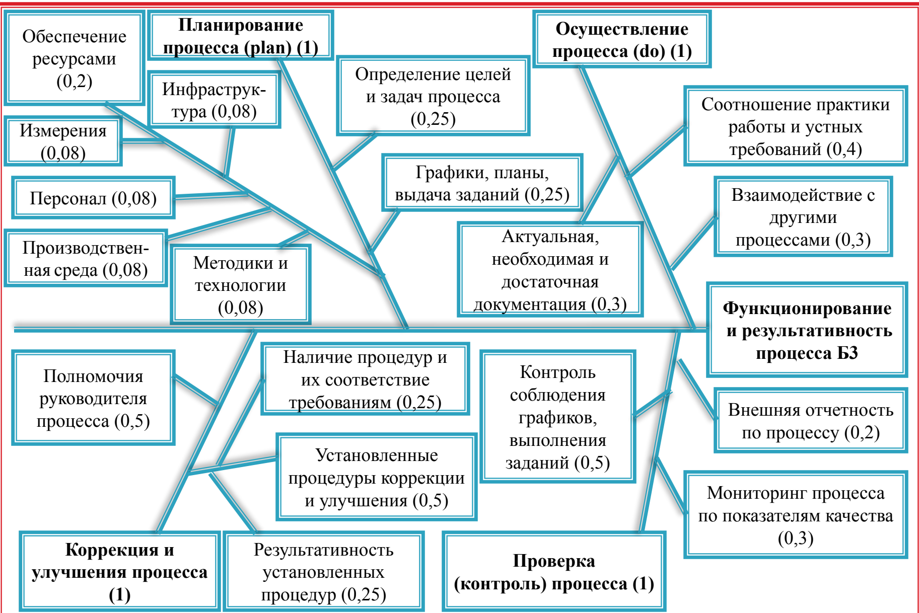
Анализ процесса БЗ «Производство печатных плат комбинированным позитивным методом» с использованием причинно-следственной диаграммы
