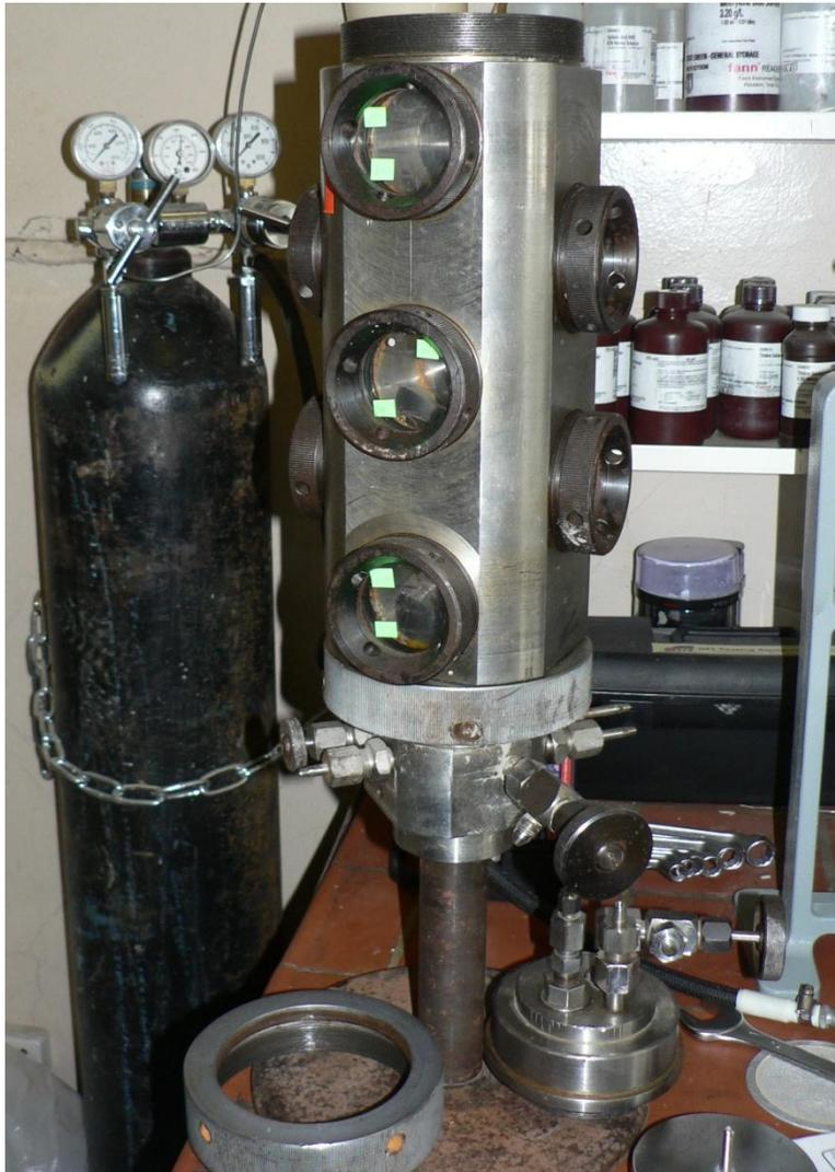
Визуальная система противодавления представляет собой стальной цилиндр со встроенными стеклянными иллюминаторами для визуального наблюдения за происходящим процессом. В систему может подаваться давление до 300 атм.
