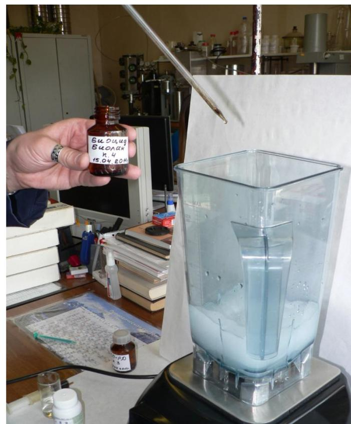
**Этап 2.** Ввод полимера ГПГ-3 и получение структурированной жидкости
