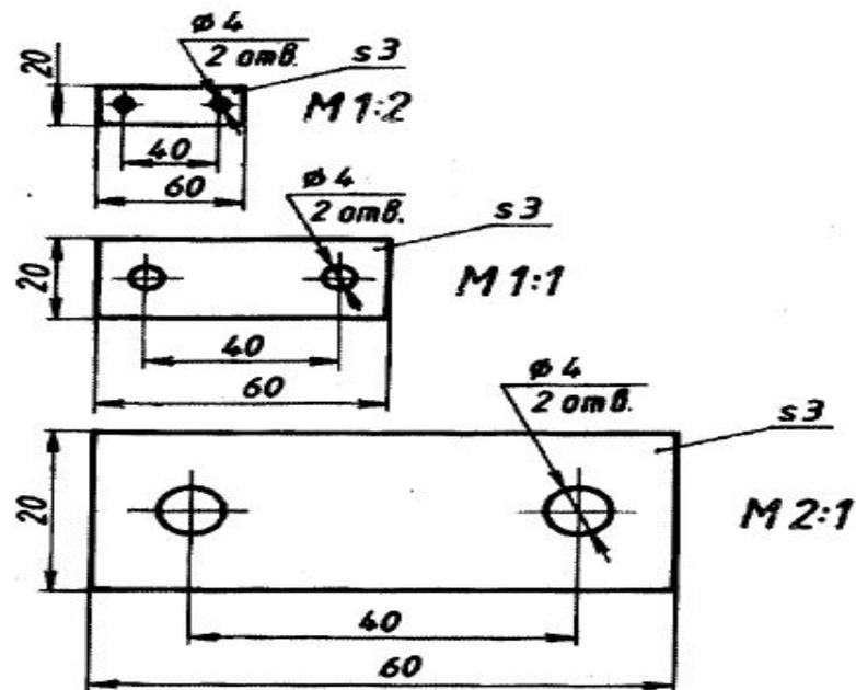
Рис. 56. Чертеж детали, выполненный в разных масштабах
