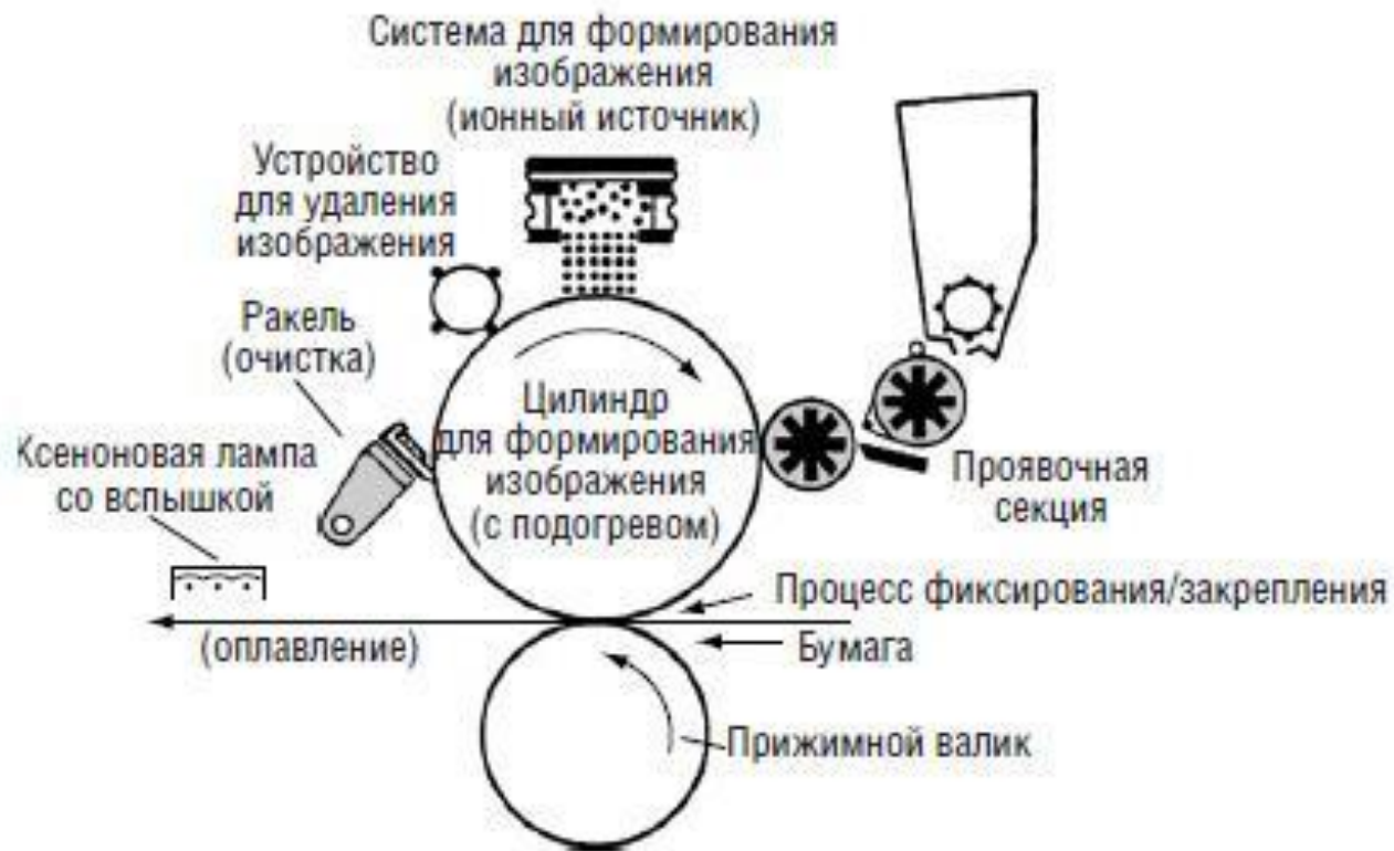
Схема построения печатной секции ионографии (Delphax)
