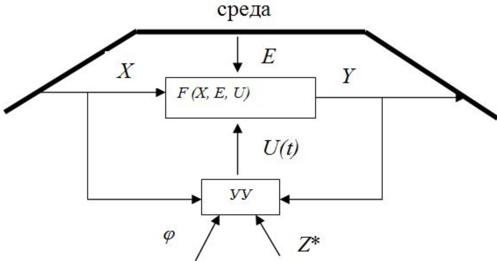
Рис. 1.6. Общая схема управления ( $Z^*$  - желаемое, целевое состояние,  $\varphi$  - алгоритм)
