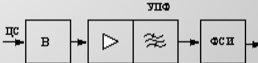
В высокоскоростных ЦСП используют **метод активной фильтрации:**
