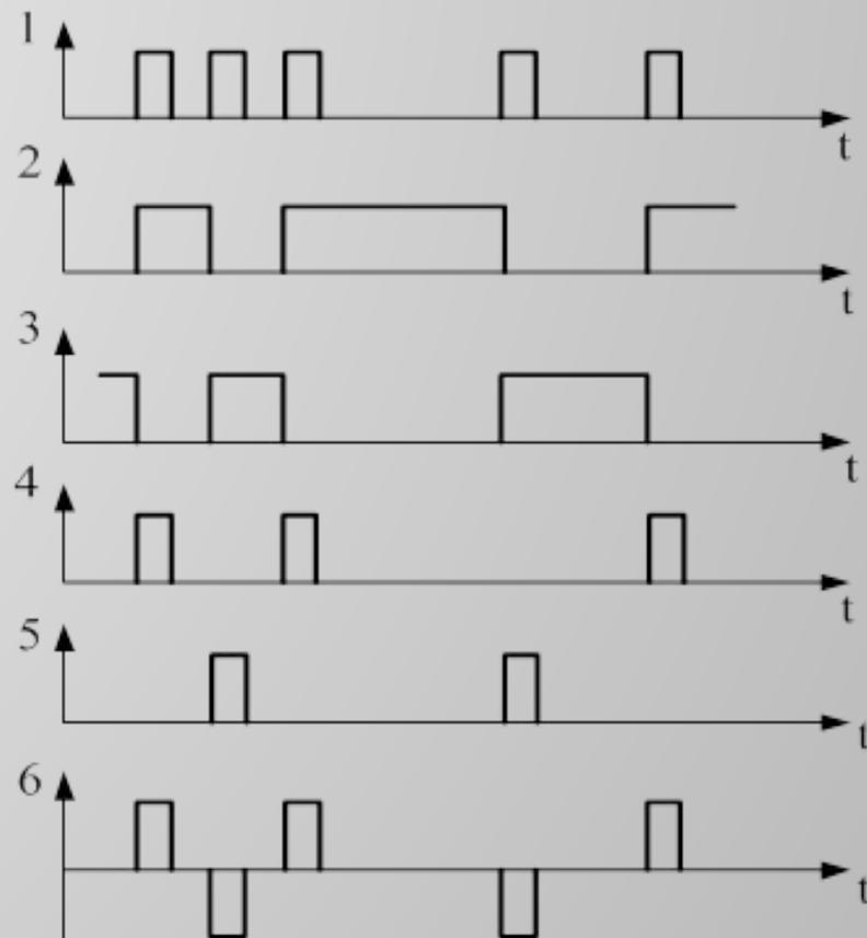
Схема преобразователя кода передачи включает в себя счетный триггер, две логические схемы «И» и трансформатор с заземленной средней точкой
