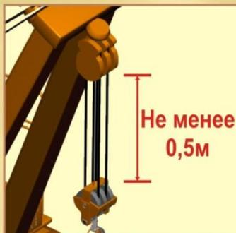
РАБОТЫ ПО ПОДЪЁМУ ГАЗОПРОВОДА ПРОИЗВОДЯТСЯ В ПРИСУТСТВИИ И ПОД НЕПОСРЕДСТВЕННЫМ РУКОВОДСТВОМ ЛИЦА, ОТВЕТСТВЕННОГО ЗА БЕЗОПАСНОЕ ПРОИЗВОДСТВО РАБОТ КРАНАМИ-ТРУБОУКЛАДЧИКАМИ. ПОДЪЁМ НЕОБХОДИМО ОСУЩЕСТВЛЯТЬ ПЛАВНО, БЕЗ РЫВКОВ И РЕЗКИХ КОЛЕБАНИЙ
