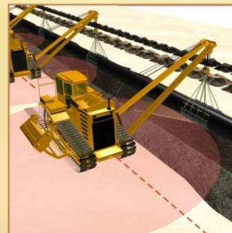
РАБОТА В ЗОНЕ ВОЗМОЖНОГО ОБРУШЕНИЯ ГРУНТА
