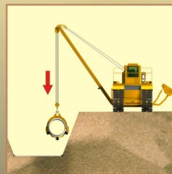
ОПУСКАНИЕ ТУБОПРОВОДА НА СТЕНКИ ТРАНШЕИ
