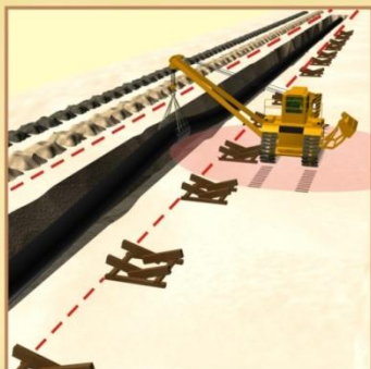
ПОДЪЁМ ТРУБОПРОВОДА ОДНИМ КРАНОМ-ТРУБОУКЛАДЧИКОМ
