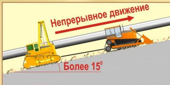
УКЛАДКА ТРУБОПРОВОДА НА ПРОДОЛЬНЫХ УКЛОНАХ БОЛЕЕ 15° ВЫПОЛНЯЕТСЯ С ИСПОЛЬЗОВАНИЕМ ТРАКТОРА-БУКСИРА ПРИ РАБОТЕ НА ПОДЪЁМ И БУЛЬДОЗЕРА-ЯКОРА ПРИ РАБОТЕ ПОД УКЛОНОМ
