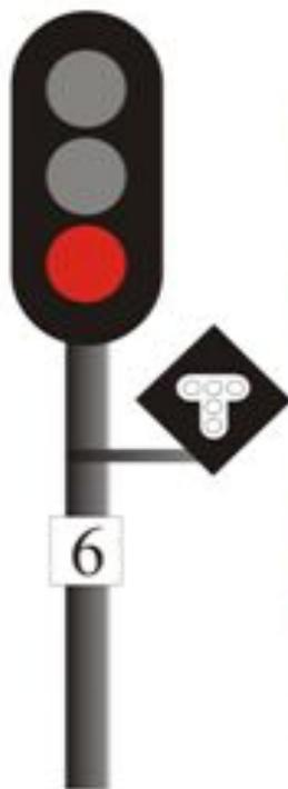
На участках с автоблокировкой на мачте **проходных светофоров**, кроме предвходных светофоров, **расположенных на затяжных подъемах** может применяться **условно-разрешающий сигнал**, подаваемый щитом с отражательным знаком прозрачно-белого цвета в виде буквы Т.
