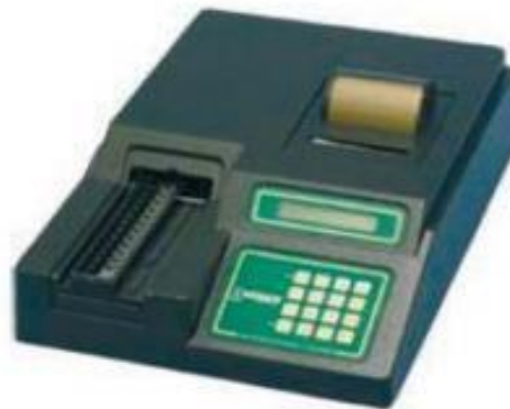
Рис. 6. Спектрофотометр StatFax 321 для количественного определения содержания микотоксинов
