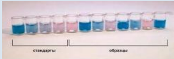
Рис. 5. Изменение цвета субстрата в зависимости от концентрации микотоксинов
