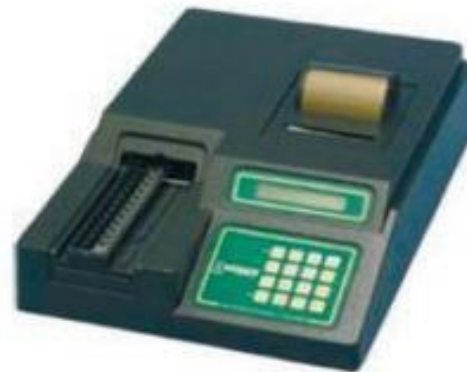
Рис. 6. Спектрофотометр StatFax 321 для количественного определения содержания микотоксинов
