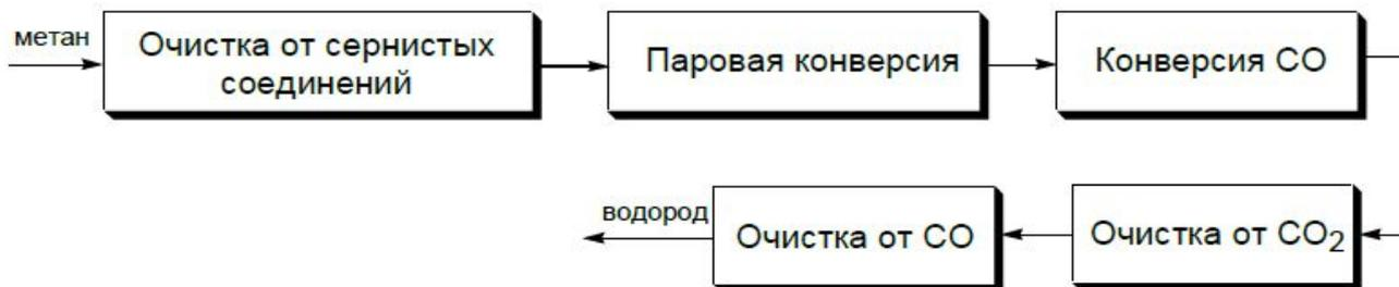
Метан под давлением около 3 МПа подогревается, а затем в целях предотвращения дезактивации катализатора очищается от сернистых и галогенсодержащих соединений. Очистка сырья осуществляется в среде водорода на гетерогенном оксидном алюмокобальтмолибденовом катализаторе.
