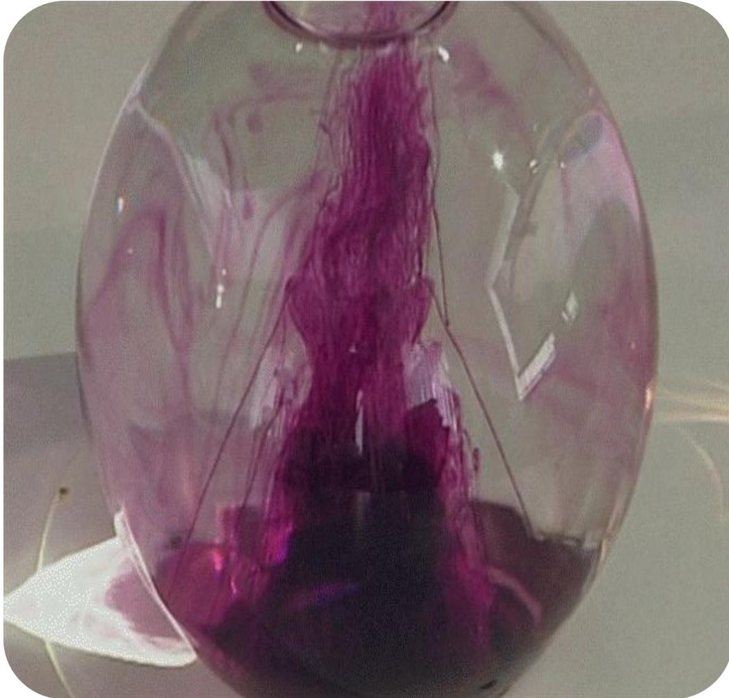
Кристаллический йод обладает способностью при нагревании переходить **из твердого состояния в газообразное**, минуя жидкое (**возгонка**), превращаясь в фиолетовые пары.
