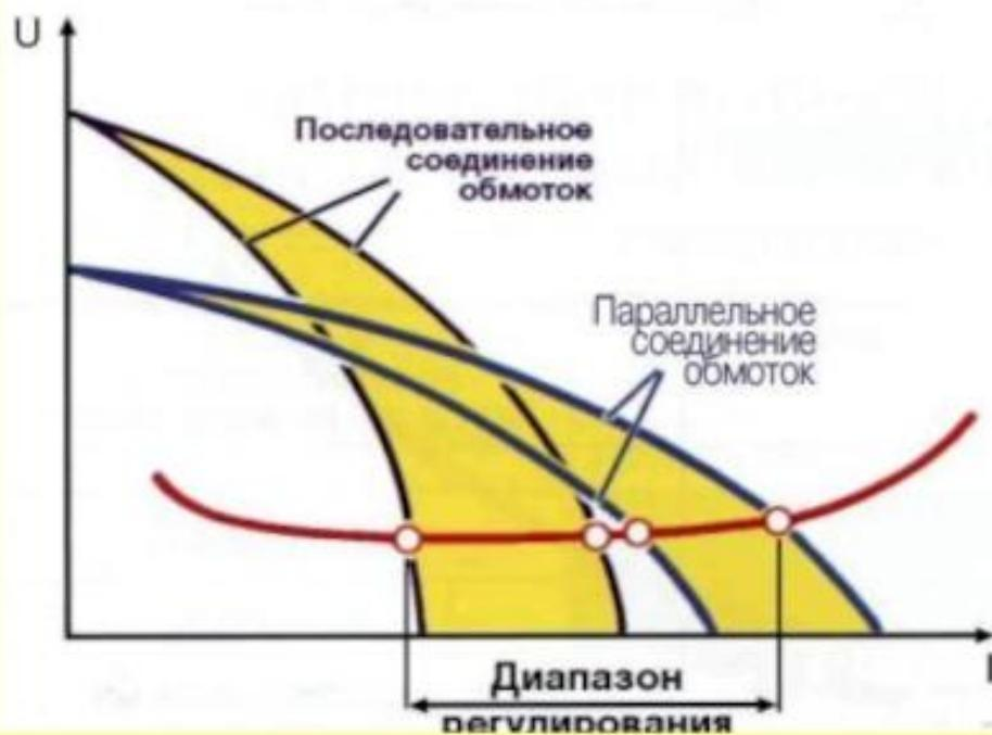
Плавно: за счет изменения зазора в катушке дросселя или между обмотками
