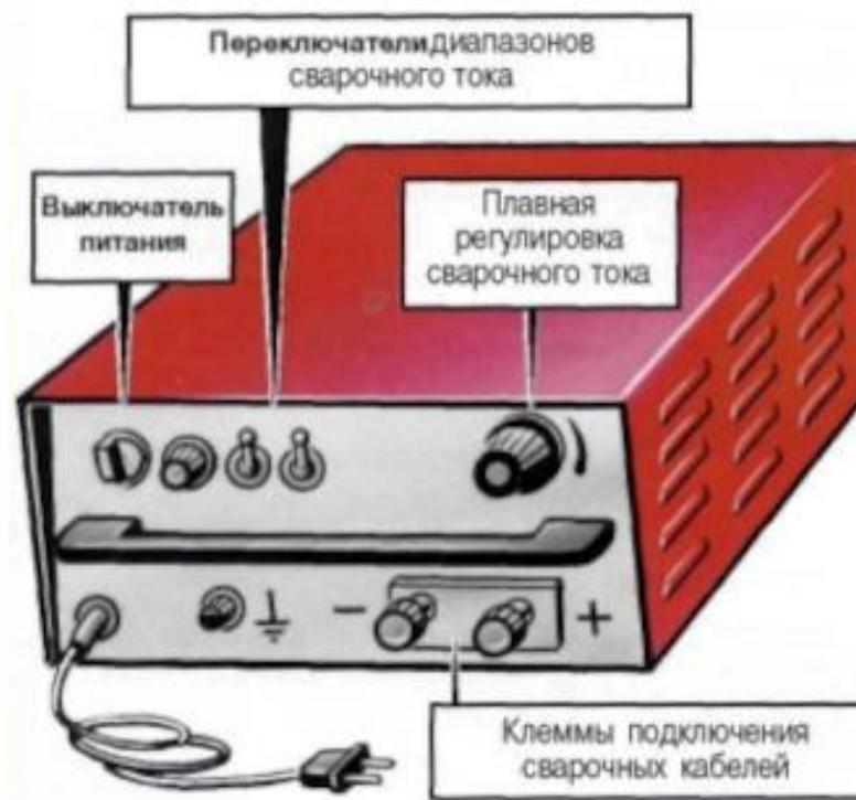
Преобразуют переменное напряжение сети в напряжение и ток для сварки
