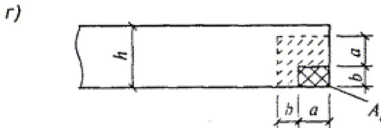
д) при площади смятия, расположенной на части длины и ширины сечения, расчетная площадь принимается согласно рис. 3. Если площадь смятия расположена вблизи от края сечения, то при расчете на сумму местной и основной нагрузок принимается расчетная площадь сечения, не меньшая, чем определяемая по рис. 2, при приложении той же нагрузки к угловому участку стены;
