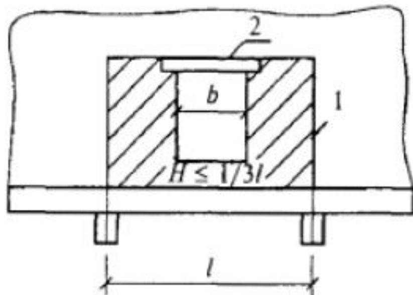
**7. Схема нагрузки на рандбалку при наличии проема в стене**
