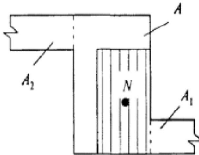
**Расчетная схема сложного сечения при косом внецентренном сжатии;
