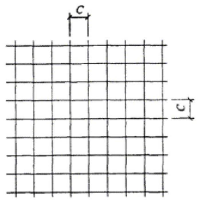
**Поперечное (сетчатое) армирование каменных конструкций**
