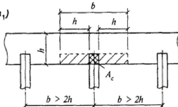
г) при смятии под краевой нагрузкой, приложенной к угловому участку стены, расчетная площадь равна площади смятия, а при расчете на сумму местной и основной нагрузок принимается расчетная площадь, ограниченная на рис. 2 пунктиром;
