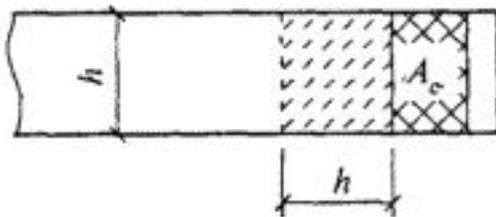
в) при опирании на стену концов прогонов и балок в расчетную площадь смятия включается площадь сечения стены шириной, равной глубине заделки опорного участка прогона или балки и длиной не более расстояния между осями двух соседних пролетов между балками ( в ); если расстояние между балками превышает двойную толщину стены, длина расчетной площади сечения определяется как сумма ширины балки  $b$  и удвоенной толщины стены  $h$  ( в1 );
