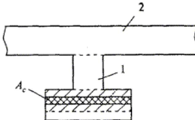
ж) при площади смятия, расположенной в пределах пилястры и части стены или простенка, увеличение расчетной площади по сравнению с площадью смятия следует учитывать только для нагрузки, равнодействующая которой приложена в пределах полки (стены) и же в пределах ребра (пилястры) с эксцентриситетом  $e_0 > 1/6L$  в сторону стены
