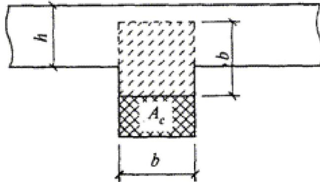
з) если сечение имеет сложную форму, не допускается учитывать при определении расчетной площади сечения участки, связь которых с загруженным участком недостаточна для перераспределения давления (участки 1 и 2 на рис. 3).
