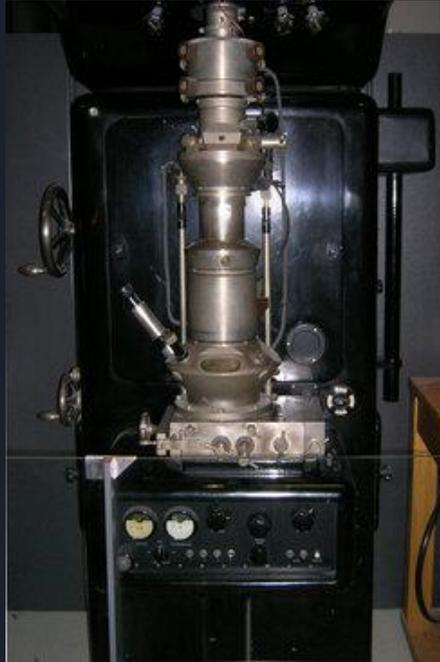
Электронная пушка производит пучок электронов, ускоренных высоким напряжением и сфокусированных через абсолютный вакуум и магнитные линзы. Затем луч пересекает образец, который предварительно был обезвожен и в некоторых случаях покрыт тонким металлическим слоем. Изображение формируется на фотографической пластине с ультрамелкозернистой эмульсией, идеально подходящей для больших увеличений.
