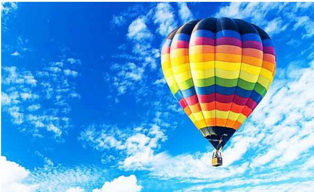
Одним из способов передвижения по воздуху – воздушный шар, заполненный более легким, чем воздух газом или просто нагретым воздухом. Началом эры воздухоплавания следует считать 183 год, когда братья Монгольфье поднялись в воздух на воздушном шаре, заполненном горячим воздухом.
